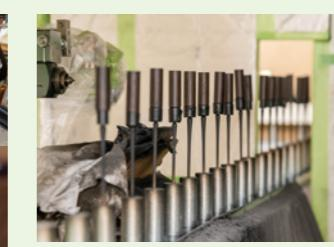
ペン軸を回転させながら下地の色づけを行なう自動塗装機。機械化により1カ月3万個の加工が可能に。
