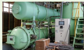
木材に不燃・防腐・高耐候性処理を行う真空加圧含浸装置。
