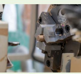
樽材を自動でカットし、口径に合わせてくり抜きを行う特注のペングリップ加工機。
