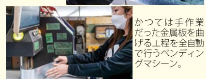
かつては手作業だった金属板を曲げる工程を全自動で行うペンドイングマシン。
